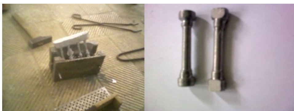
Figure.4. Moules métallique pour éprouvettes d'essais
