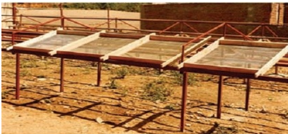
Figure 1: Séchoir à claies inclinées Lac Fitri – Yao
