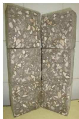
Figure 11. Eprovettes sciées (absence de ségrégation)
