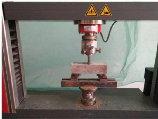
(a) Essai de traction par flexion.
