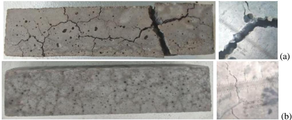
**Figure 11 :** Fissuration des éprouvettes des mortiers, (a) mortier sans additions minérales
